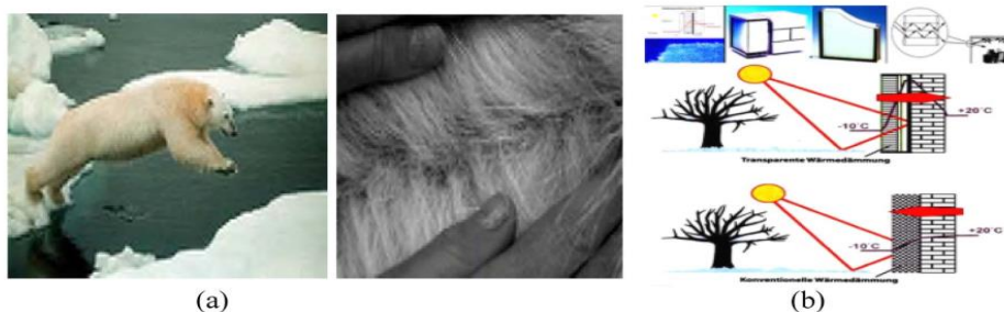
شکل ۱۱. ساختار TIW (الف) خرس قطبی با پوست سیاه و موی روشن؛ (ب) اصول عایق گرمایی TIW
