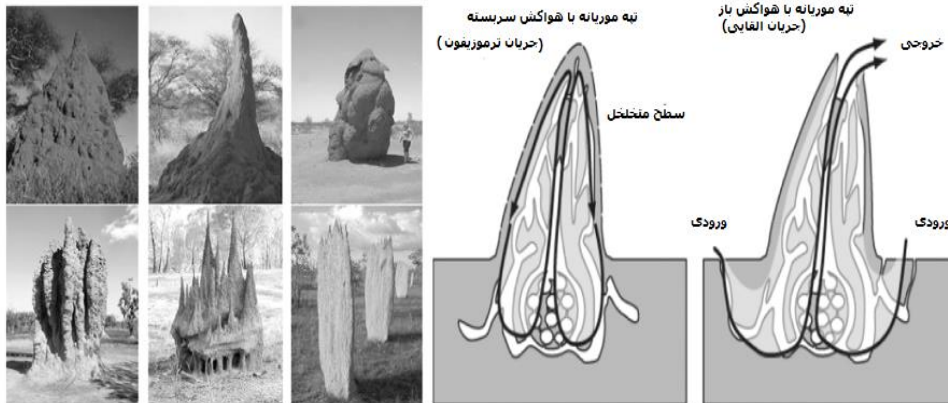
شکل ۲. تعدادی تپه موربانه و ساختار درونی آنها (الف) طرح اولیه لانه موربانه؛ (ب) جریان هوای تهویه؛ (ب) سمت چپ: تصویری می‌شود که جریان ترموزیفون در لانه‌های دارای هواکش بسته اتفاق می‌افتد؛ (ت) راست: تصویری بر این است که جریان القایی در لانه‌های دارای هواکش باز اتفاق می‌افتد؛ ماخذ: Zari MP 2019
