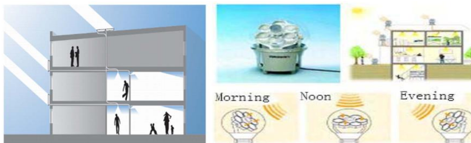
شکل ۵. موارد کاربرد روشنایی طبیعی بیونیک الف) اصل روشنایی با الیاف نوری؛ ب) سیستم‌های روشنایی الیاف نوری آفتابگردانی در ژاپن.
