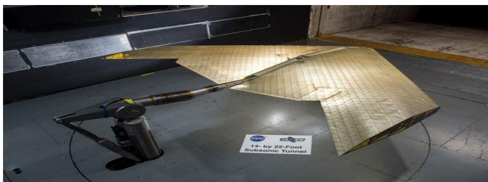
تصویر ۱. سازه مورفینگ متحرک که براساس سنسورها به محیط واکنش می‌دهد؛ ماخذ: آرشیو نگارندگان.
